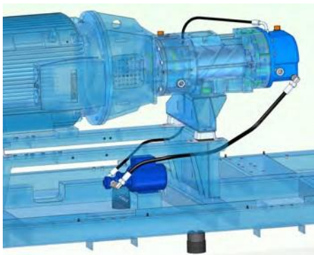
Рис. 16: Насос для смазки редуктора ступени компрессора
