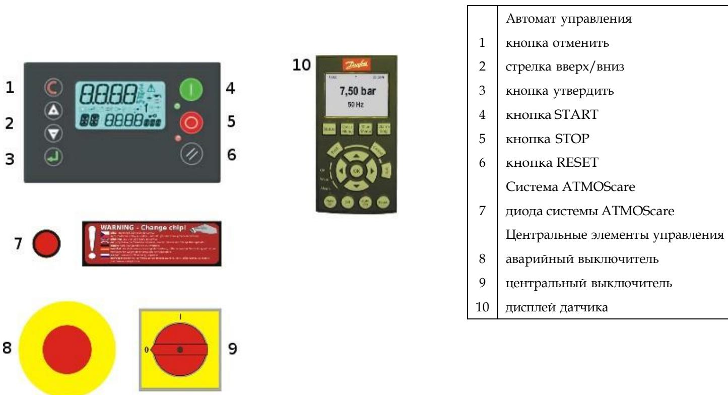
Все функции компрессора управляемы контролером находящимся на переднем панеле. Кнопками стрелок (вверх и вниз) можно переключать указанные данные на дисплее (температура, рабочие часы и под.). Кнопка RESET служит к аннулировании тревожных входов (если тревога не находится в постоянной активности) и к возвращении на исходный экран.
