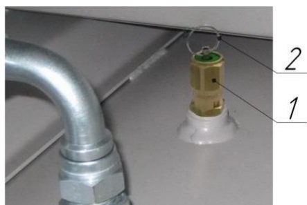
Рисунок 11 – Клапан предохранительный пружинного типа
