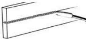
Рисунок 23. Сварка в горизонтальном положении
