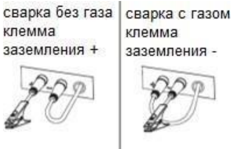
Рисунок 17. Полярность при полуавтоматической сварке
