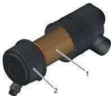
Рис. 42: Разборка корпуса воздушного фильтра
